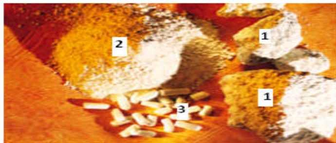
**Figure I.2:** Photo montrant différents aspects du kaolin, 1) Roche ; 2) poudre de tout-venant ; 3) poudre finie mise sous forme vermicelles [13].
