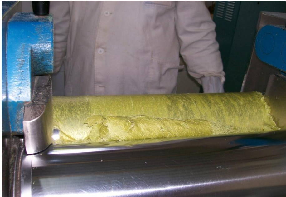
Figure 8: Photo de la préparation des films par calandrage.
