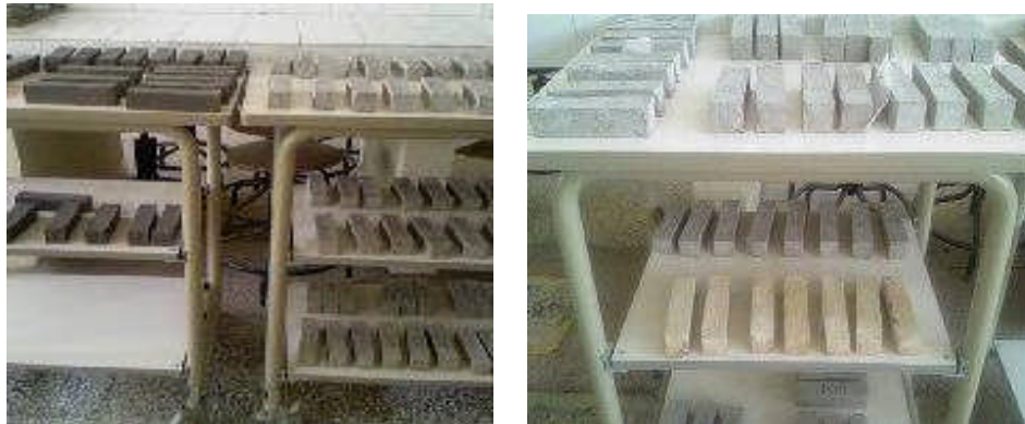
Figure IV.5 : Spécimens des briques confectionnées (cuites et non cuites)
