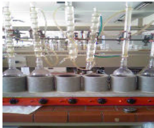
Figure III.4 : Appareil pour la détermination de l'ADF
