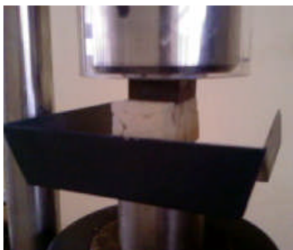
Figure IV.16 : Essai de la résistance à la compression
