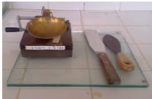
Figure IV.2: Appareil de Casagrande et outil à rainurer
