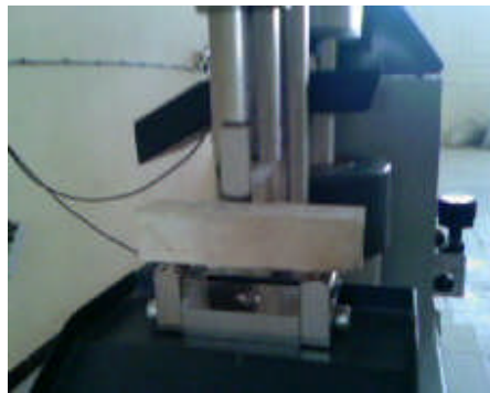
Figure IV.14 : Essai de la résistance à la flexion
