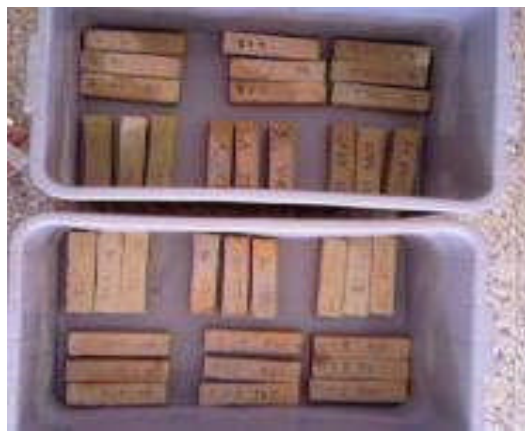
Figure IV.12 : Détermination du coefficient d'absorption d'eau
