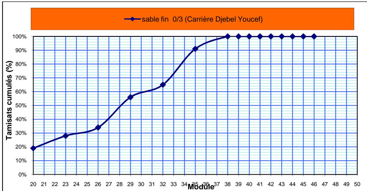
Figure III.2. Courbe granulométrique du sable fin (Carrière Djebel Youcef)
